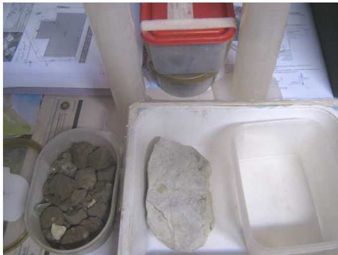
Misura della densità del substrato roccioso
