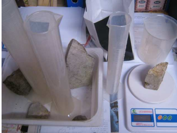
Misura della densità di alcuni frammenti rocciosi presi dal pendio
