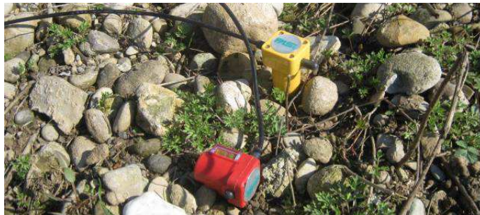
Punto di energizzazione, sismografo e geofoni
