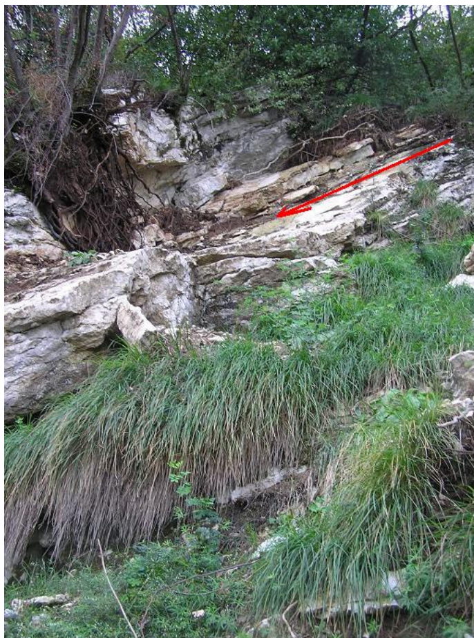
Fotografia 2 – Cinematismi mediante scivolamento planare (la freccia poggia sul piano di scivolamento e ne indica la direzione). La fotografia è relativa all'area di distacco del blocco n° 3 (vedi anche Tavola fotografica – zona A).
