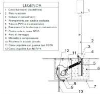
PARTICOLARE n. 6 - sc. 1:20 POZZETTO LAMPIONE
